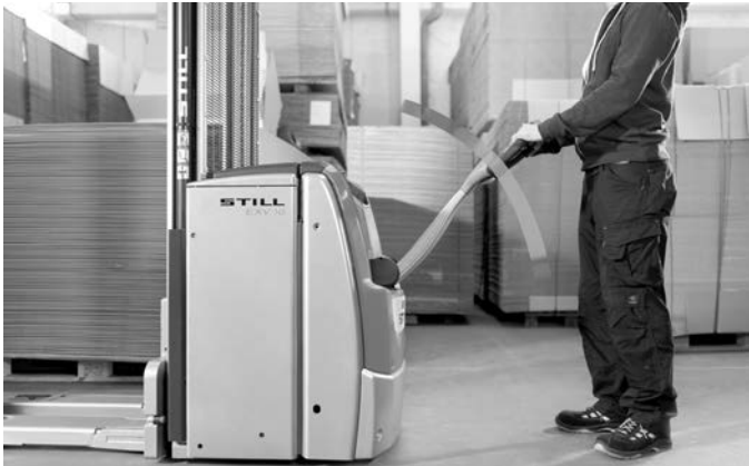
Sicherheit in Serie: Geschwindigkeit passt sich deichselwinkelabhängig automatisch an den Abstand des Fahrers zum Fahrzeug an
